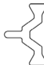
图2 非 I 型聚酰胺型材截面典型示例
